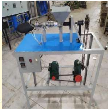
Gambar 2.1 Hasil rancangan alat ekstruder
