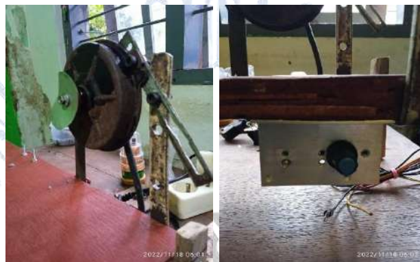
Gambar 4.7 Pemasangan bagian motor (a) Pemasangan motor (b) Pemasangan pengatur kecepatan motor
