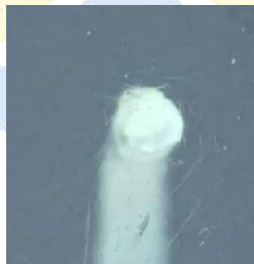
Gambar 4.18 Filamen dengan suhu 200°C
