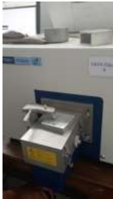
Peletakan spesimen pada alat uji komposisi
